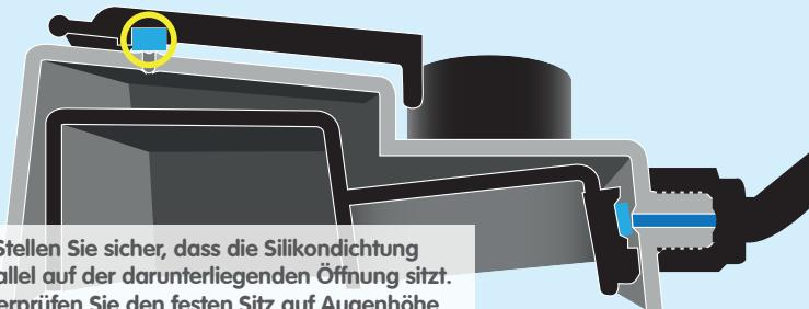
Stellen Sie sicher, dass die Silikondichtung parallel auf der darunterliegenden Öffnung sitzt. Überprüfen Sie den festen Sitz auf Augenhöhe.
