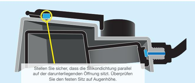
Stellen Sie sicher, dass die Silikondichtung parallel auf der darunterliegenden Öffnung sitzt. Überprüfen Sie den festen Sitz auf Augenhöhe.
