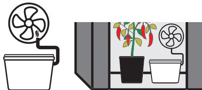
Posizionare sempre il generatore di CO<sub>2</sub> sul pavimento, non sollevarlo mai. Se si dispone di un ventilatore o di un sistema di circolazione dell'aria, posizionare il tubo superiore del generatore nella parte posteriore del ventilatore di circolazione in modo che la CO<sub>2</sub> sia distribuita uniformemente in tutto l'ambiente di coltivazione.
