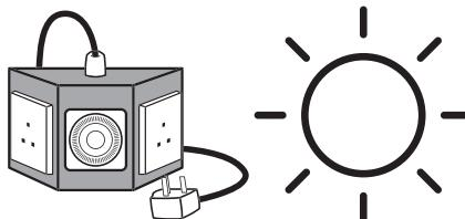
Per ottenere risultati ottimali, azionare il generatore di CO<sub>2</sub> a intermittenza a "luci accese". Utilizzando un timer, impostare il generatore in modo che funzioni per 5-10 minuti e poi si spenga per 60 minuti. Ripetere con questo ritmo per tutto il periodo di "luci accese" per garantire un ampio apporto di CO<sub>2</sub>. A "luci spente", il generatore deve essere completamente spento.
